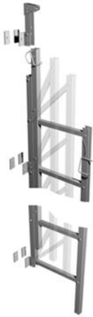
Kuva 4. Periaatekuva aukeavasta tikkaasta
